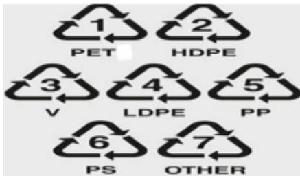
注: PET-ポリエチレンテレフタレート、HDPE-高密度ポリエチレン、PVC-塩化ビニル、LDPE-低密度ポリエチレン、PP-ポリプロピレン、PS-ポリスチレン、その他、ABS（アクリロニトリル ブタジエン スチレン）、PPO（ポリフェニレンオキシド）、PC（ポリカーボネート）、PBT（ポリブチレンテレフタレート）など他の全ての樹脂及び複合材料を意味する。
